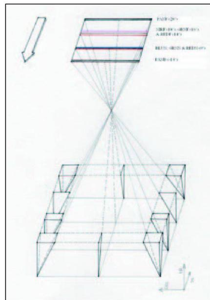
Fig. 2: Principe de la précision planimétrique des orthophotos.
