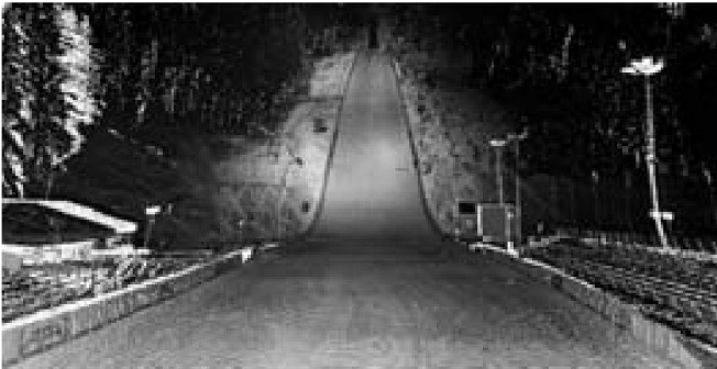
Abb. 1: Punktwolke eines Scans von der Engelberger Skisprungschanze.
