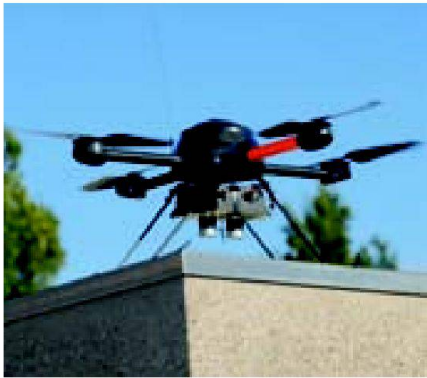
Abb. 3: Multispektralkamera im Einsatz unter der Mikrodrohne.
