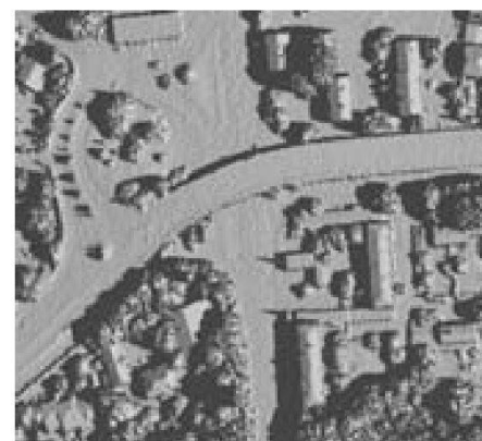
Abb. 2: Ausschnitt eines aus Laserdaten abgeleiteten Digitalen Oberflächen-Modells der Stadt Genf (4 P/m², 0.5 m Raster).
