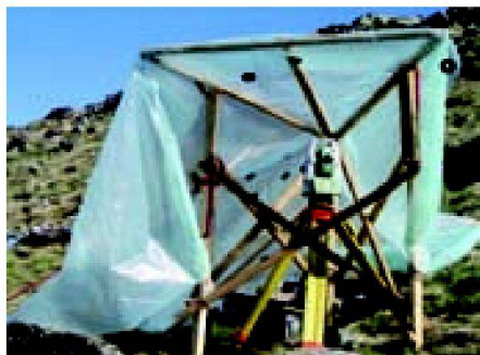
Abb. 4: Automatisierte Totalstation im temporären Schutzstand auf festem Untergrund seitlich des Dirru-Blockgletschers.
