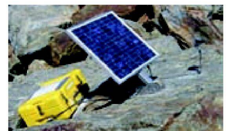
Abb. 3: GPS-Permanentstation am unteren Rand des Blockgletschers. Der Koffer beinhaltet den GPS-Empfänger, einen Datenlogger und eine Solarbatterie mit Laderegler. Rechts neben dem Solarpanel befindet sich die GPS-Antenne.
