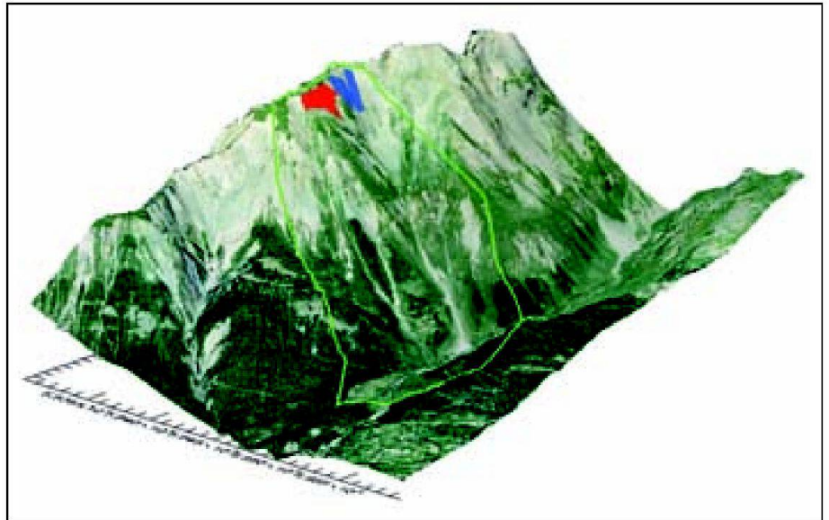
Abb. 1: SLF Testgelände Vallée de la Sionne (VS) mit zwei Anrissgebieten an der Crêta-Besse mit unterschiedlicher Anrisshöhe (rot 1.5 m, blau 1 m). Um die Rechenzeit zu optimieren wird das Untersuchungsgebiet eingeschränkt (grünes Polygon). Abb. 3 zeigt das Resultat dieser Simulation (swissimage ©2010 swisstopo DV03349.2).
