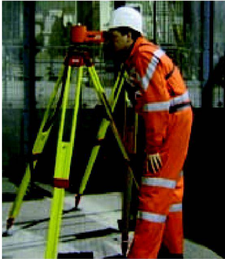
Abb. 4: Nadirlot am Schachtkopf.
