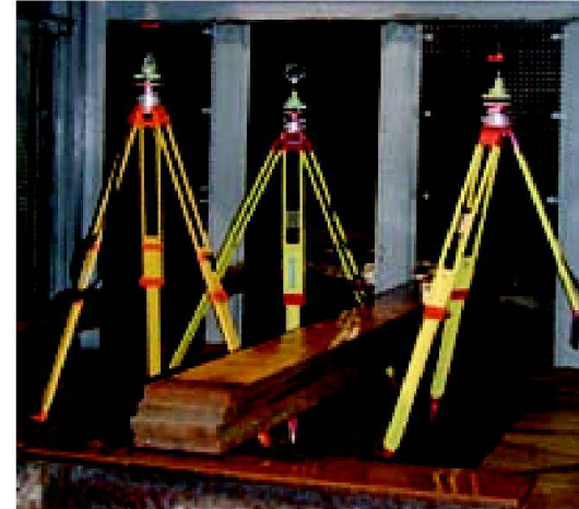
Abb. 5: Positionierung der Stative am Schachtfuss.
