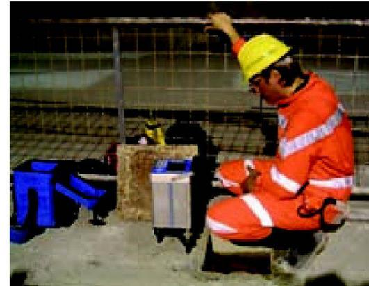
Abb. 4: Schweremessung im Tunnel.
