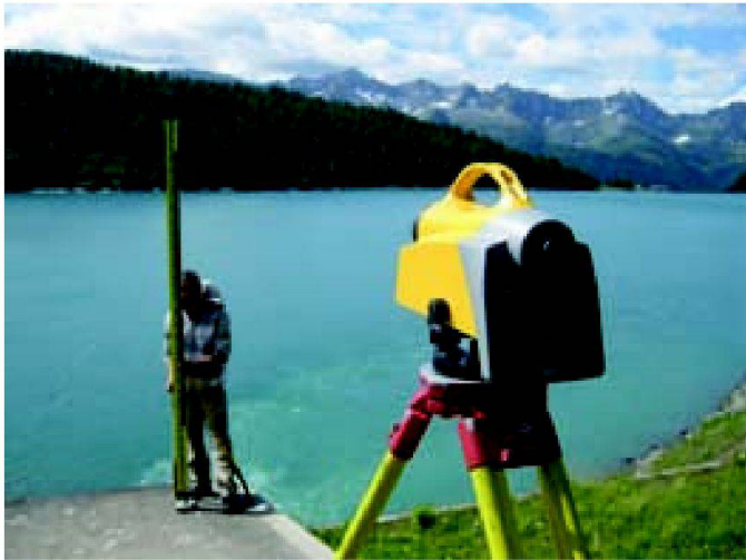
Abb. 4: Nivellementmessung beim Ritomsee.
