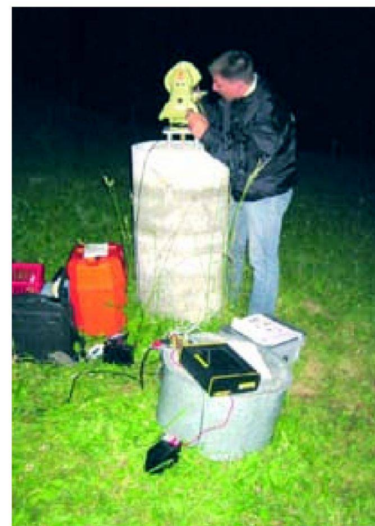
Abb. 4: Mitautor Sébastien Guillaume als Geomatik-Student am Messen eines astro-geodätischen Azimuts zwischen einer terrestrischen Mire und dem Polarstern ( \alpha Ursae Minoris).
