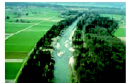
Abb. 69 > Revitalisierung Flaz Kombination Hochwasserschutz und Revitalisierung mit neuem Flusslauf des Flaz
