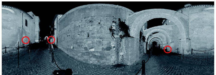
Abb. 3: Die abgerollte Punktwolke ergibt ein Intensitätspanorama (roter Kreis: zu detektierende Verknüpfungskugel).
