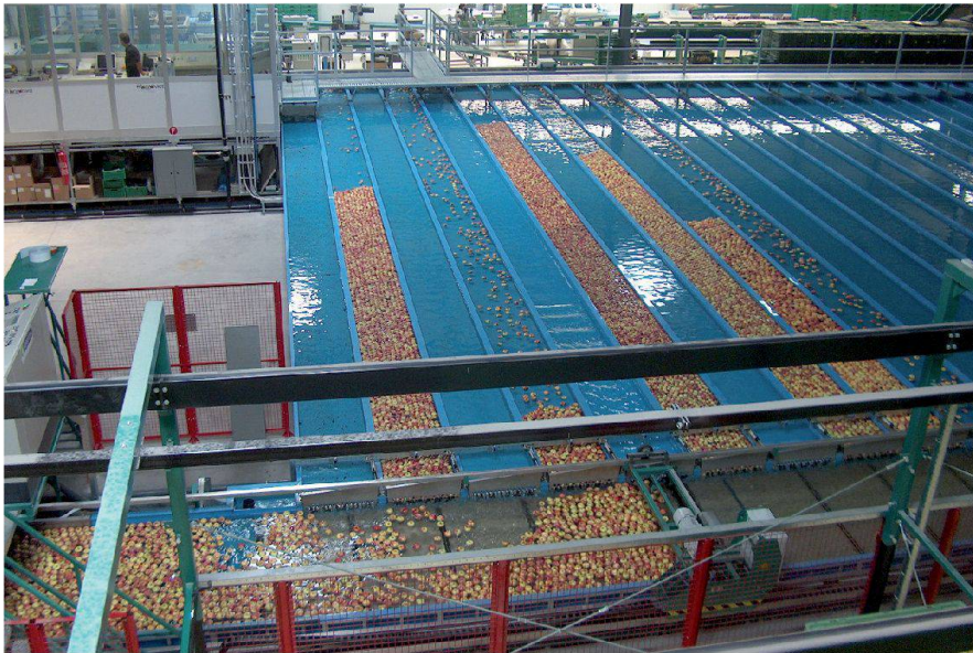
Fig. 2: Installation de triage de la production au moyen de canaux à eau.
