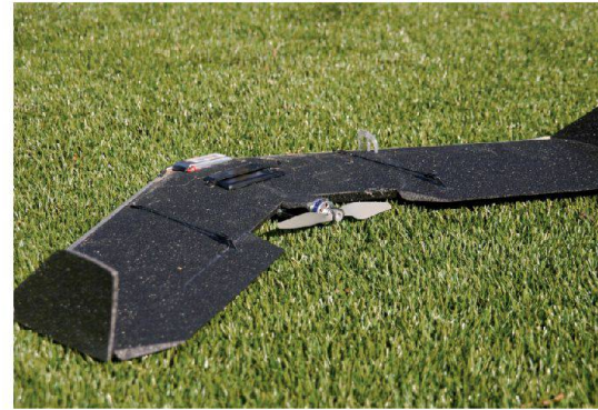
Fig. 1: L'aile prête au décollage, avec batterie, caméra et moteur+hélice.
