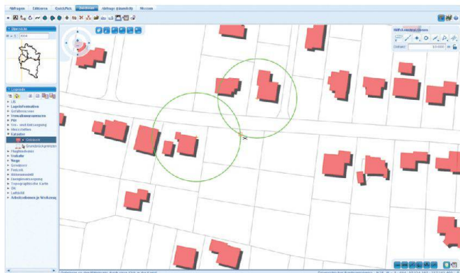
Abb.: Benutzeroberfläche des GeoMedia® Smart Client mit Punkt-Fangfunktionen (Snapping) und Konstruktionshilfen.
