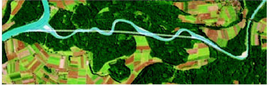
Abb. 2: Die Thurmündung: Der Rhein fliesst im Bild von oben nach unten, die Thur von rechts nach links. Die Thur erhält ihre Dynamik zurück, auf den Gleithängen der neuen Mäander werden sich tief liegende Weichholzauen bilden.
