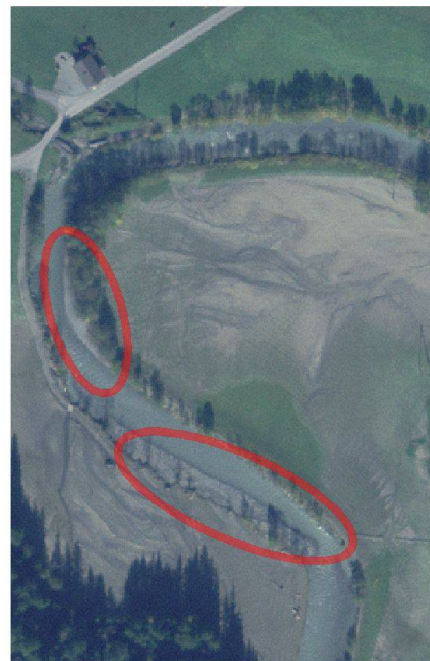
Abb. 4: Links: 13.10.2011 (Flotron AG), die Kander oberhalb Kandersteg führt drei Tage nach dem Ereignis immer noch viel Wasser. Rechts: 17.10.2011 (swisstopo), Auflandungen im Gerinne sind erst auf den Aufnahmen zu erkennen, welche sieben Tage nach dem Ereignis aufgenommen wurden.
