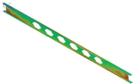
Fig. 11: La poutre type «Angelina» avec la coloration des déformations (les parties rouges et bleues représentent des défauts principaux allant jusqu'à 8 mm).
