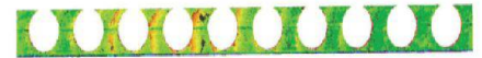
Fig. 8: Inspection entre les deux faces de l'âme. Le résultat montre que dans le secteur où les lasers frappent proches de la normale à la surface, les distances entre les faces sont trop petites par rapport à des contrôles mécanique (coloration jaune, voir rouge).
