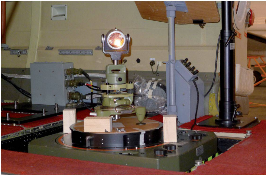
Fig. 2: Le PAV30, l'origine du système de coordonnées local (prisme) ainsi que la matérialisation des axes de coordonnées (blocs en bois).
