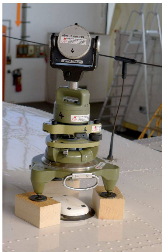
Fig. 4: Prisme au-dessus de l'antenne GNSS.
