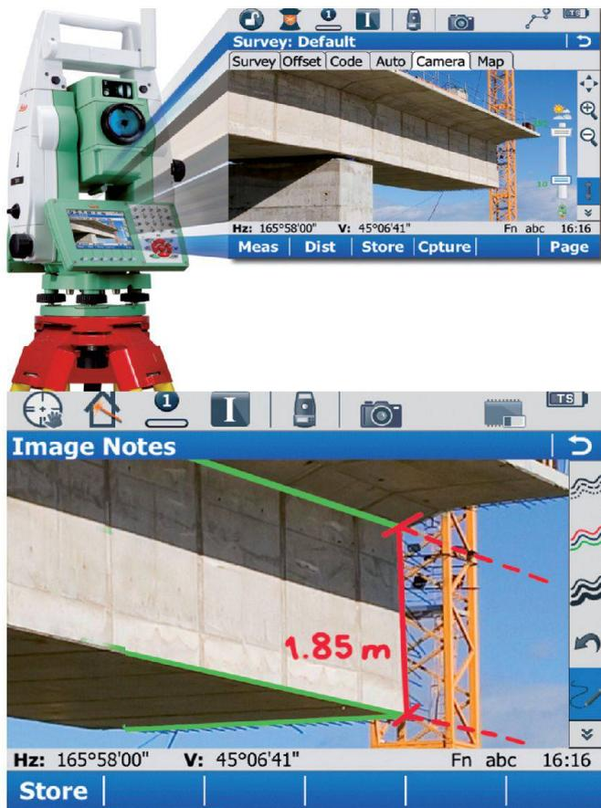
Gemessene Punkte, Linien und Flächen werden auf das Videobild überlagert, das mit der hochauflösenden Kamera der Viva TS11i oder TS15i Totalstation erfasst wurde.
