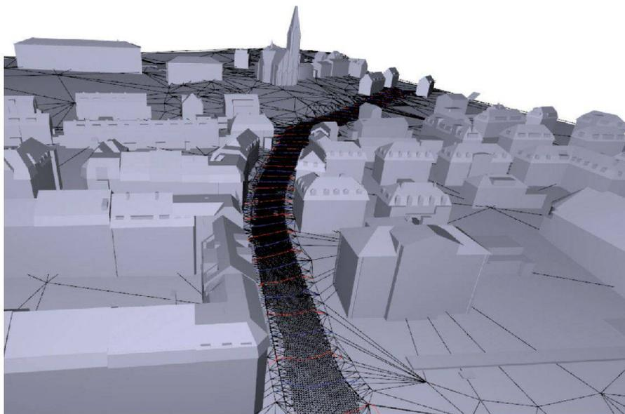
Abb. 6: Geländemodell kombiniert mit dem 3D-Stadtmodell (Quelle: GeoZ).
