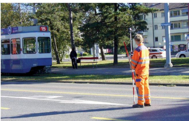
Abb. 4: Tachymetrische Passpunktbestimmung einer Strassenmarkierung (Quelle: GeoZ).
