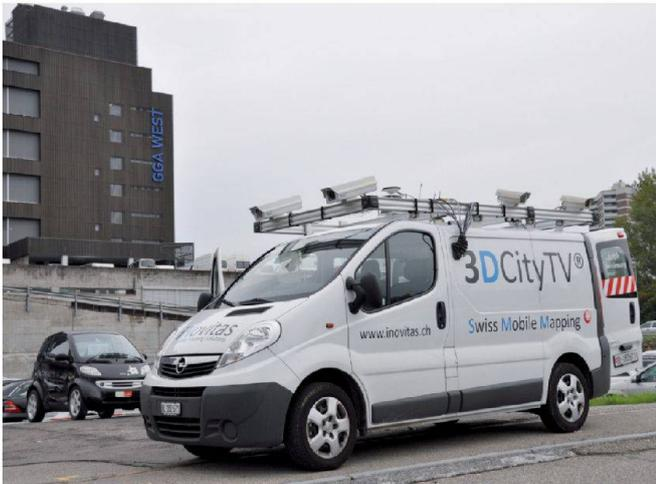
Abb. 2: Mobile Mapping Fahrzeug von iNovitas (Quelle: GeoZ).
