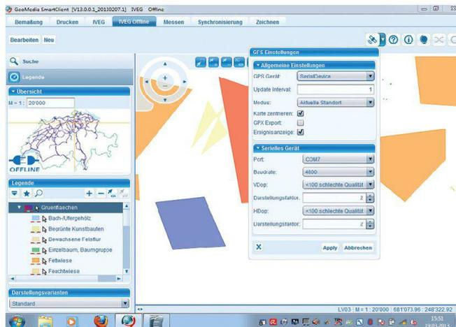
Abb. 2: GMSC im Offline Modus, Lokalisierung über GPS.
