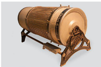
Abb. 1–4: Ende 2013 wurden am Departement Informatik der ETH Zürich und im Konzernarchiv der UBS Basel gleich zwei sehr seltene, über 100-jährige Loga-Rechenwalzen mit einer Skalenlänge von 24 m gefunden. In der Mitte der seitlich verschiebbare und drehbare Schieber. Nach unserem Wissen handelt es sich dabei um die weltweit grössten Rechenwalzen. (© Hansjörg Leimer/Daniel Nasshan, UBS AG, Basel und Zürich).
