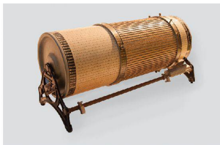
Abb. 1–4: Ende 2013 wurden am Departement Informatik der ETH Zürich und im Konzernarchiv der UBS Basel gleich zwei sehr seltene, über 100-jährige Loga-Rechenwalzen mit einer Skalenlänge von 24 m gefunden. In der Mitte der seitlich verschiebbare und drehbare Schieber. Nach unserem Wissen handelt es sich dabei um die weltweit grössten Rechenwalzen. (© Hansjörg Leimer/Daniel Nasshan, UBS AG, Basel und Zürich).
