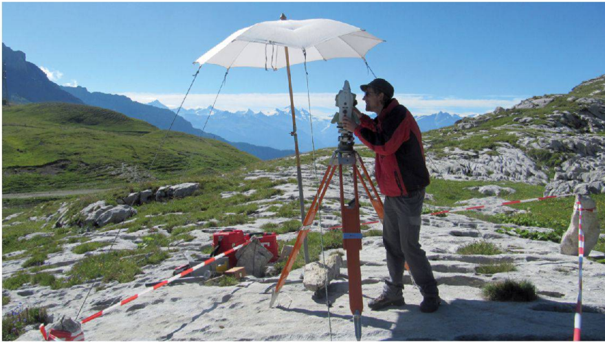
Abb. 4: Einmessung der Rückversicherungen nahe dem Sanetschpass.
