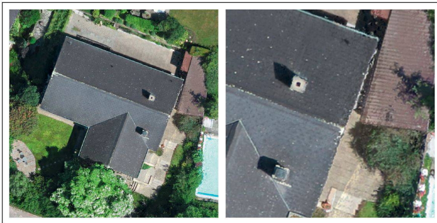
Abb. 1: Orthofoto im Massstab 1:500 (links) und im Massstab 1:200 (rechts): Leichte Verzerrungen an den Dachkanten sind nur im hohen Ansichtsmassstab sichtbar (Bodenauflösung 3 cm).
