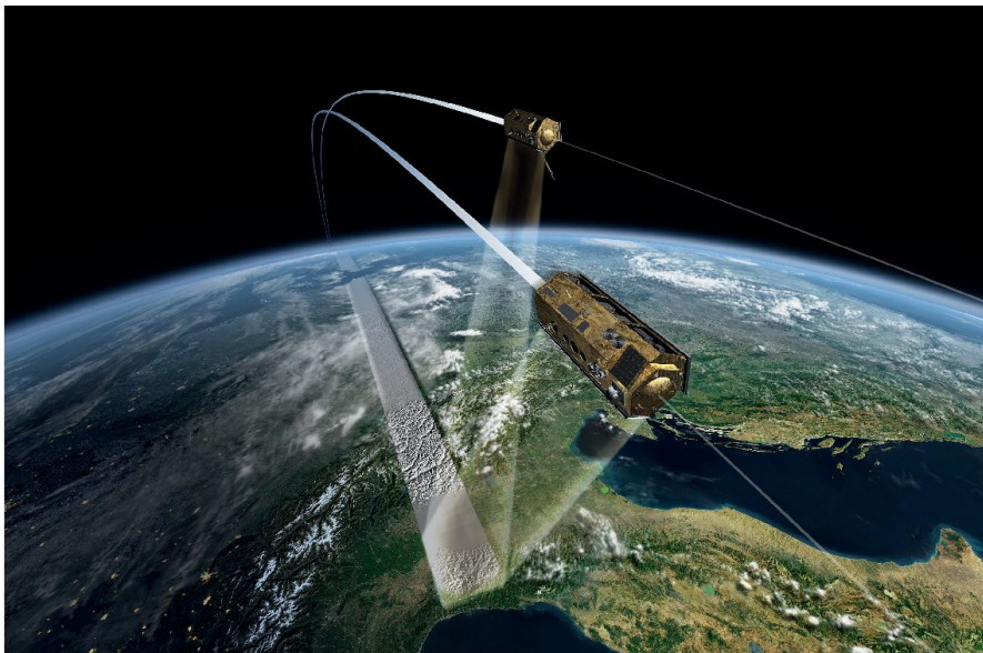
Fig. 5: Principe de l'élaboration du produit WorldDEM à partir de la constellation TerraSAR-X / TanDEM-X.
