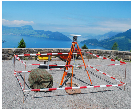
Abb. 17: GPS-Messung CHTRF2010 auf dem LV95-Punkt Emmetten (Foto: swisstopo).
