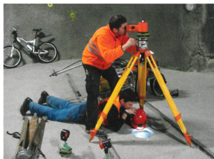
Abb. 9: Präzisionszentrierung über Vermessungspunkt im Labor mit Zentrierschlitten und Nadirlot.
