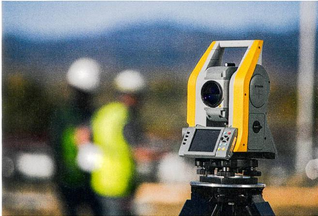
Bei der Trimble C5 handelt es sich um eine mechanische Totalstation der neuesten Generation. Sie eignet sich bestens für Anwender, die nur gelegentlich Vermessungsarbeiten durchführen. Einfache Bedienbarkeit, Robustheit und Verlässlichkeit im Feld sind
