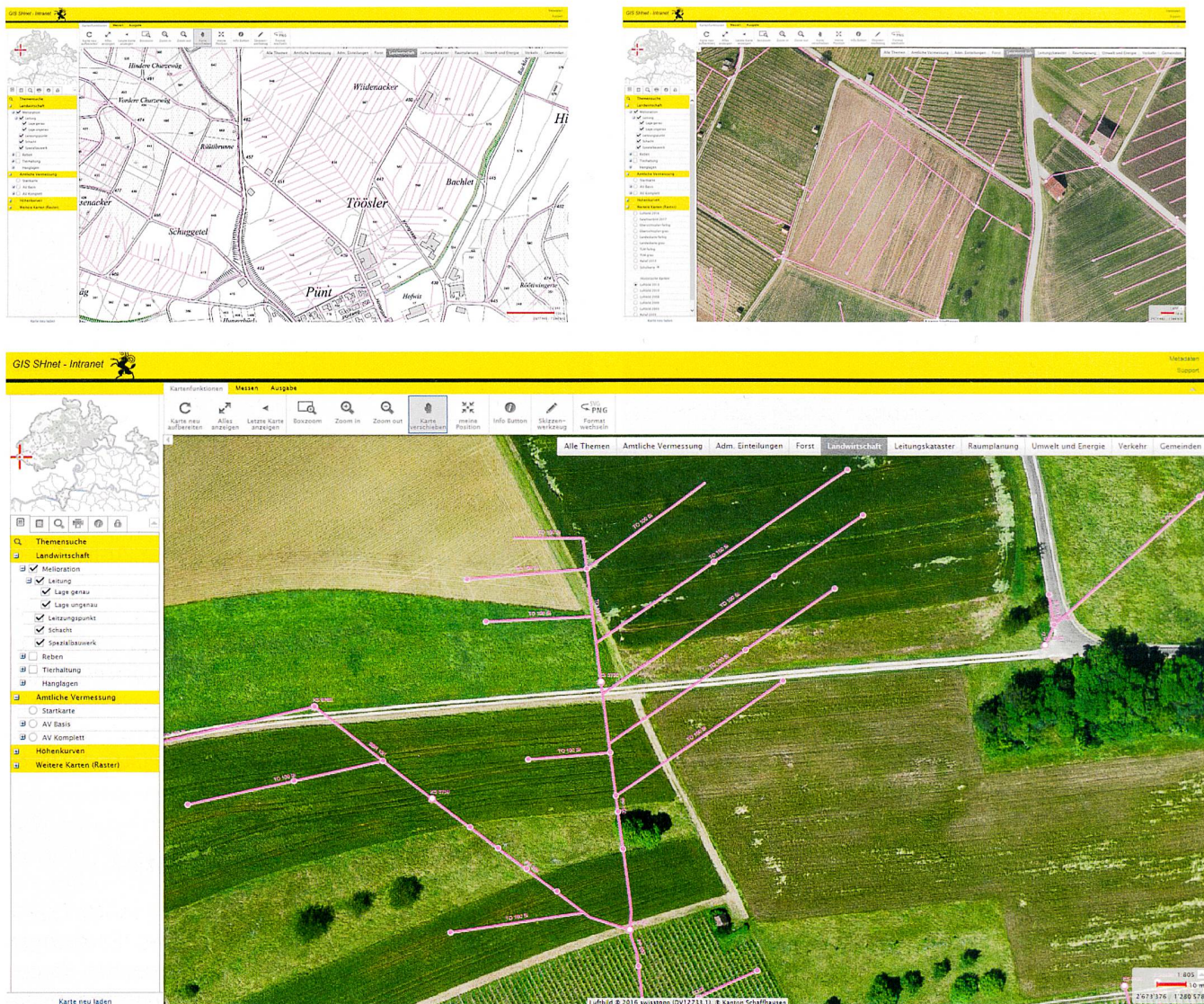
Abb. 3–5: GIS SH: Meliorationsleitungen.
