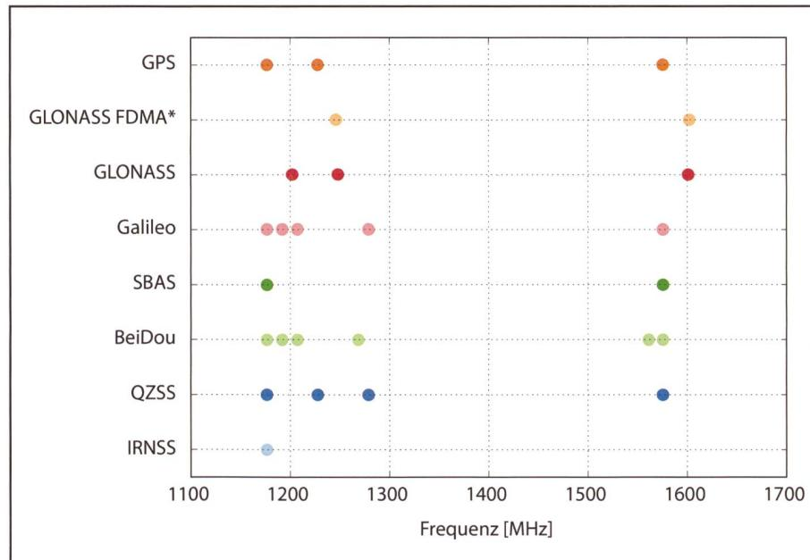
Fig. 2: Systèmes de navigation par satellites actuellement disponibles et fréquences associées. L'IRNSS indien émet en outre sur une fréquence d'environ 2500 MHz (non présentée). \*Les satellites russes d'ancienne génération émettent un signal d'accès multiple par répartition en fréquence (AMRF), la fréquence des différents satellites s'écarte de 8 MHz au plus de la fréquence centrale présentée ici.
