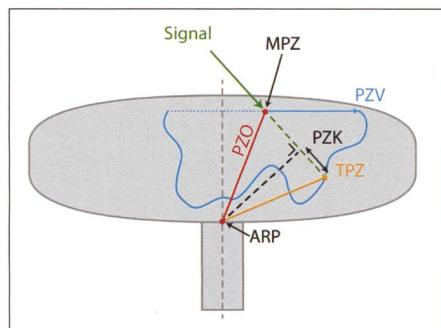
Abb. 1: GNSS-Antenne mit den relevanten Größen. Die Korrektur, die auf eine Messung angebracht wird, ist die Projektion des Vektors vom ARP zum TPZ auf den Richtungsvektor zum Satelliten.
