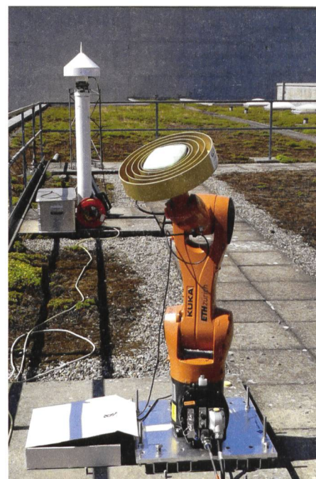
Abb. 3: KUKA 6-Achsen Industrieroboter auf dem Dach des Instituts für Geodäsie und Photogrammetrie der ETH Zürich auf dem Höggerberg. Im Hintergrund ist die Referenzantenne zu sehen.
