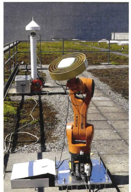
Fig. 3: Robot industriel KUKA à six axes sur le toit de l'Institut de géodésie et de photogrammétrie de l'ETH Zurich au Hönggerberg. L'antenne de référence est visible à l'arrière-plan.
