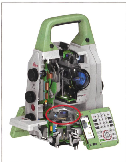
Abb. 7: Schnittmodell ScanStation mit Flüssigkeitskompensator.
