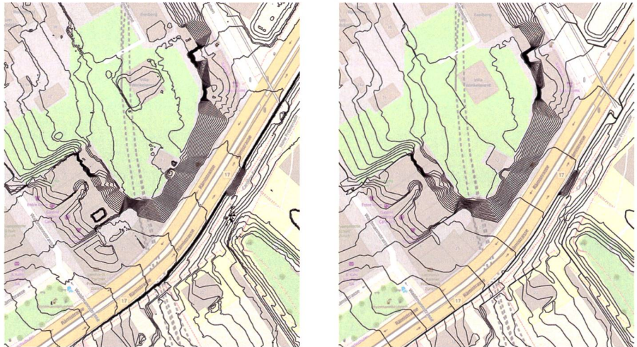
Abb. 5: Ausschnitt Rämistrasse: Höhenkurven anhand der «naiven» Anwendung des Werkzeuges «Contour» von ArcMap auf das DHM 2019 (links). Neue Höhenkurven, die mit dem beschriebenen Prozess erzeugt werden (rechts). Massstab: 1:750. Basemap: © OpenStreetMap contributors.
