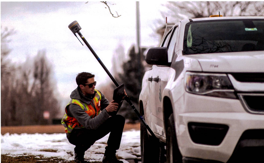
Der neue R12i: Immer präzise und überall einsatzbereit. Kalibrierungsfreie und gegen magnetische Störungen unempfindliche IMU-basierte Neigungskompensation dank TIP-System™ (Trimble® Inertial Platform™). Das GNSS-Positionierungsmodul Trimble ProPoint™ sorgt für höhere Genauigkeit und Produktivität unter herausfordernden GNSS-Umgebungsbedingungen.
