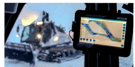
Fig. 9: Champ d'application de swipos®: positionnement en temps réel par GNSS d'une dameuse, écran dans sa cabine (photo swisstopo).
