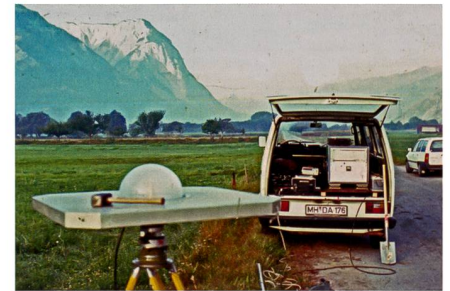
Abb. 1: Erster geodätischer GPS-Empfänger Macrometer V-1000 im 3D-Testnetz Turtmann 1985. Im Vordergrund: Antenne; Empfänger und Stromversorgung im Fahrzeug (Foto swisstopo).
