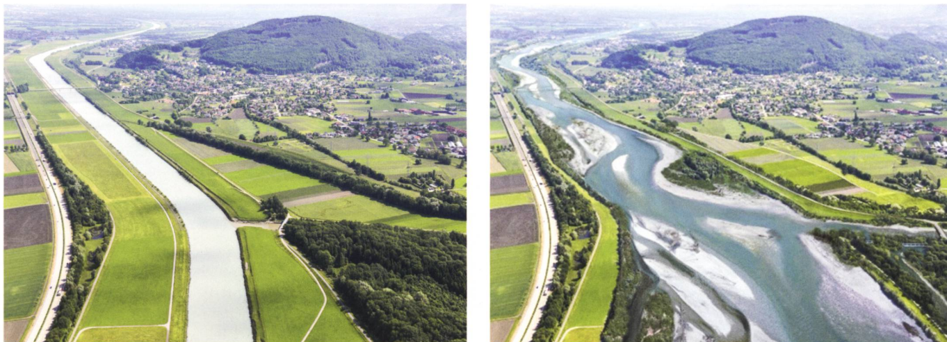
Abb. 2: Alpenrhein im Abschnitt Oberriet-Koblach heute (links) und visualisiert für Zustand nach Umsetzung Projekt (rechts). Die Gerinnebreite in diesem Abschnitt beträgt neu bis zu 380 m. Visualisierung Büro Hydra GmbH.
