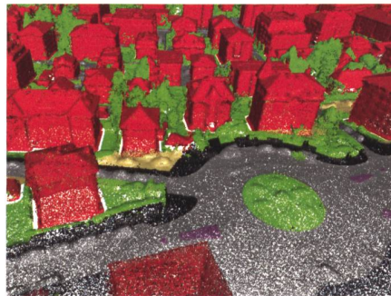
Fig. 7: Passage d'un nuage de points 3D classifiés à des polygones 2D.
