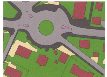
Fig. 7: Passage d'un nuage de points 3D classifiés à des polygones 2D.
