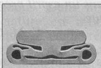
**3e cran:** Lors d'une charge brève et extrême, le troisième cran amortit les chocs et la suspension revient immédiatement en 1re ou 2e position.
