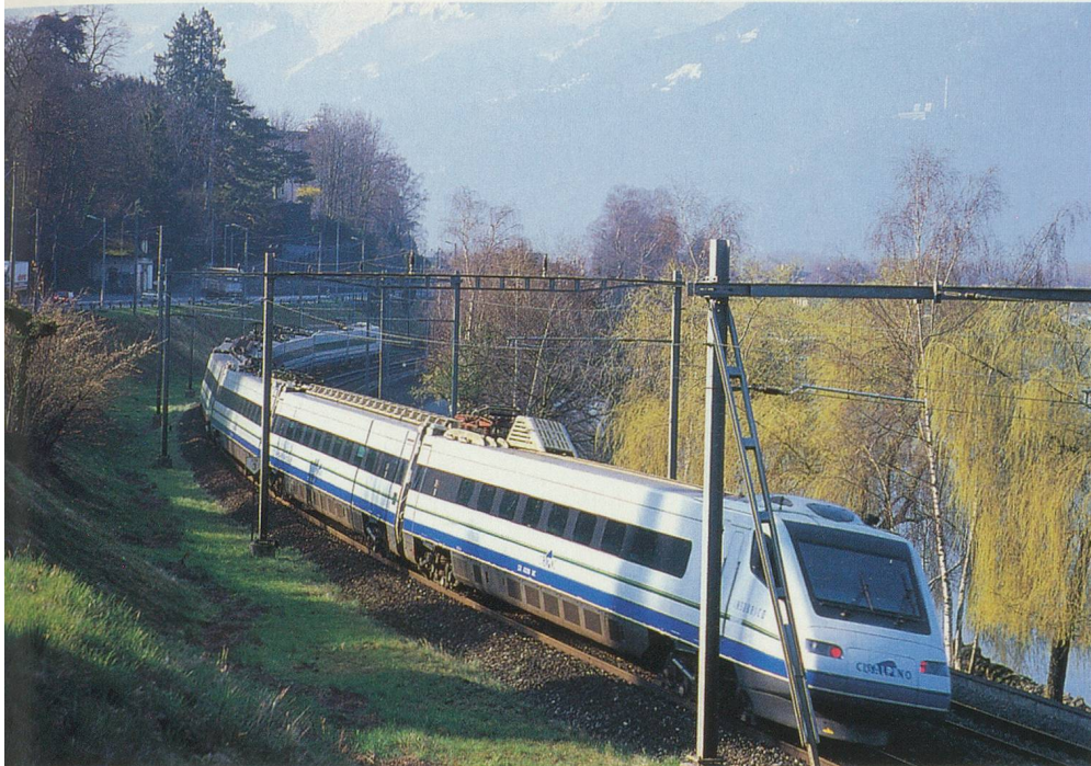
Le Pendolino épouse parfaitement les courbes en s'inclinant
