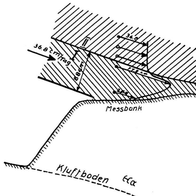
Fig. 3. Schematisches Geschwindigkeitsprofil durch die ausgequetschte Schicht I.
