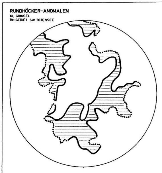
Fig. 19: Anomalien von 3 Rundhöckern oberhalb Gwüest (Göschener Alp). – Entsprechendes Kluff-Diagramm: Fig. 5. 1 = +/- Anomalienflächen. 2 = Anschluß der Anomalienfläche an überbesetztes Kluffgebiet. 3 = Anschluß an unterbesetztes Kluffgebiet.
