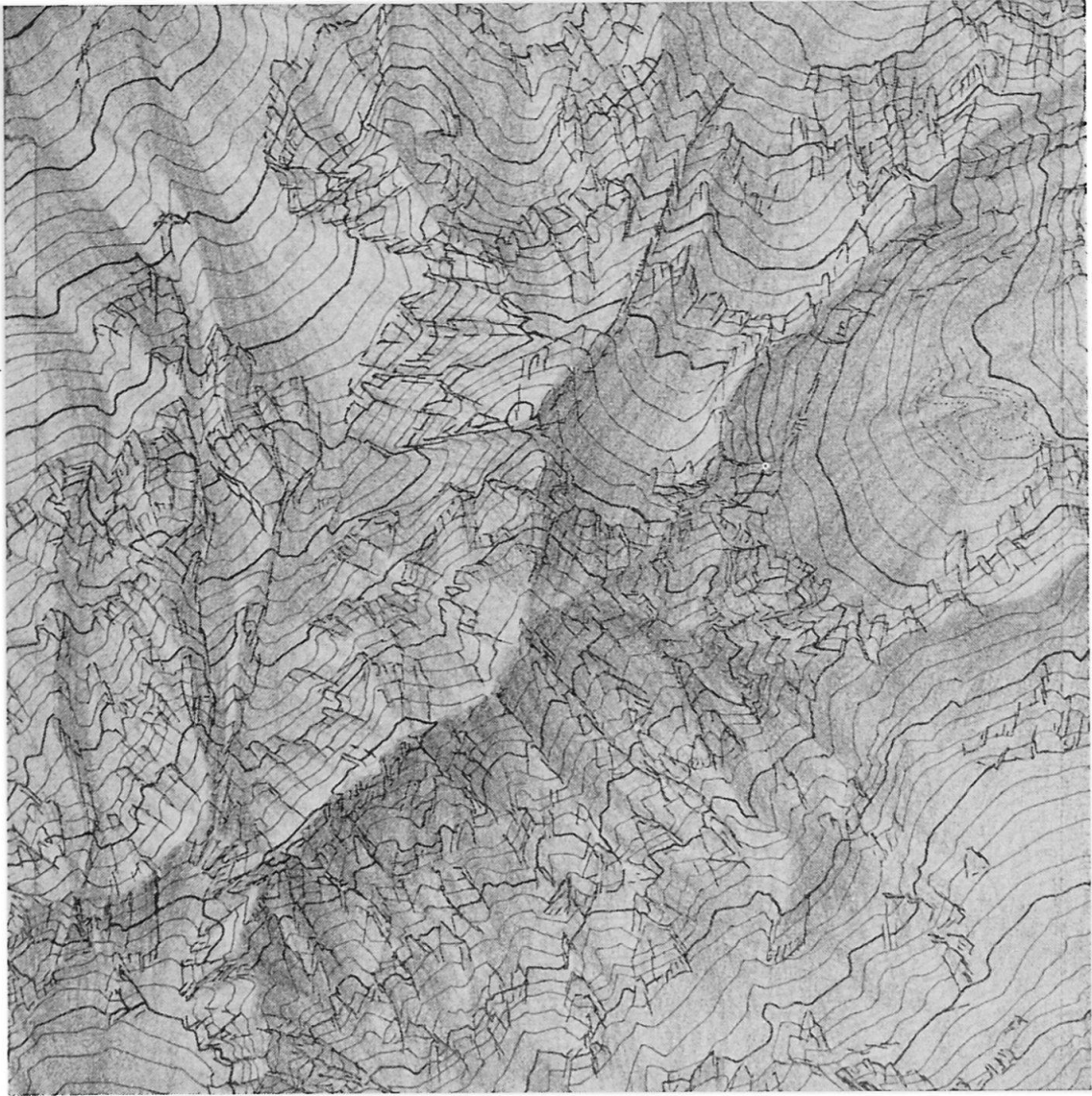
Abb.13 Ausschnitt aus dem Übersichtsplan Val d'Arpetta, Clochers d'Arpetta. Äquidistanz 20 m. Felskurven, Felslinien und Reliefton. Zeichnung und Bemalung vom Verfasser. Felslinien offen, damit Platz für Eintragungen, was dem Zweck des Übersichtsplanes entspricht. 1:1
