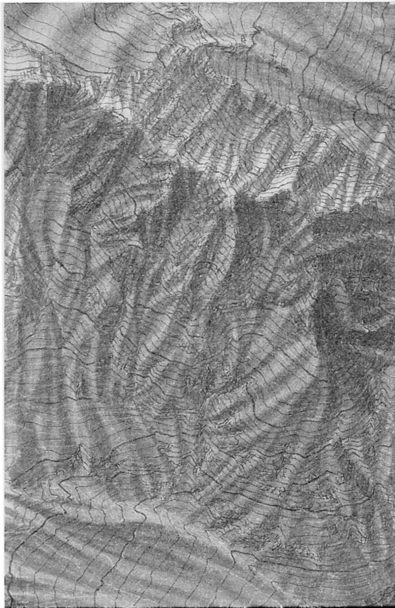
Abb. 14 Ausschnitt aus dem Übersichtsplan Val Ferret. Six Niers. Äquidistanz 20 m. Relief ton in schiefer Beleuchtung, luftperspektivisch abgestimmt. Jede Felszeichnung, sei sie in Schraffen oder photogrammetrisch mit Linien, hat sich in den Tonwerten diesem Relief ton einzupassen. Zeichnung und Bemalung vom Verfasser. Verkleinert
