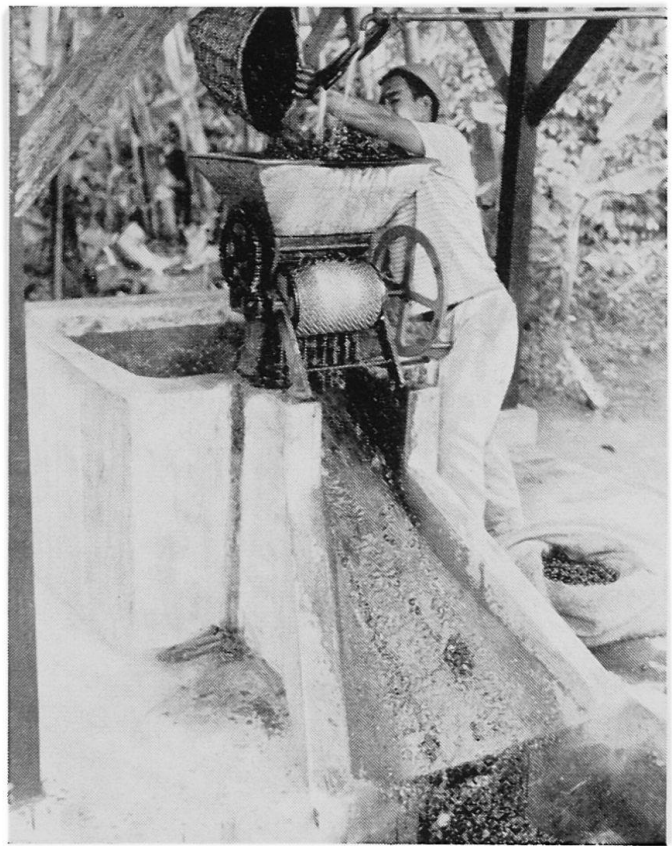
Abbildung 2. Despulpadora. Mit von Hand getriebenen Enthülsungsmaschinen werden die Kaffeebohnen von der fleischigen Umhüllung, der Pulpa, befreit
