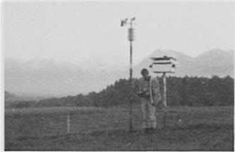
Photo 1 Kontinuierliche Messung und Aufzeichnung von Temperatur, Feuchtigkeit, Windrichtung und Windstärke
