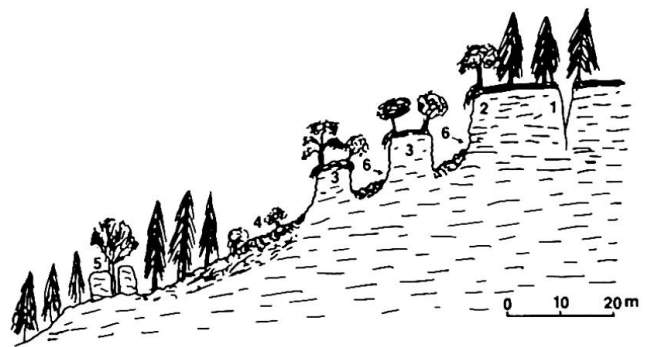
Figure 1 Le Château Cugny: coupe schématique des lieux. 1. échancrure profonde, 2. paroi principale avec racines d'arbres pendant dans le vide, 3. «châteaux», 4. éboulis, 5. gros blocs éboulés, 6. localisation des mesures.
