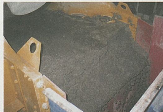
Materialfluss innerhalb der Flotationsmaschine.
