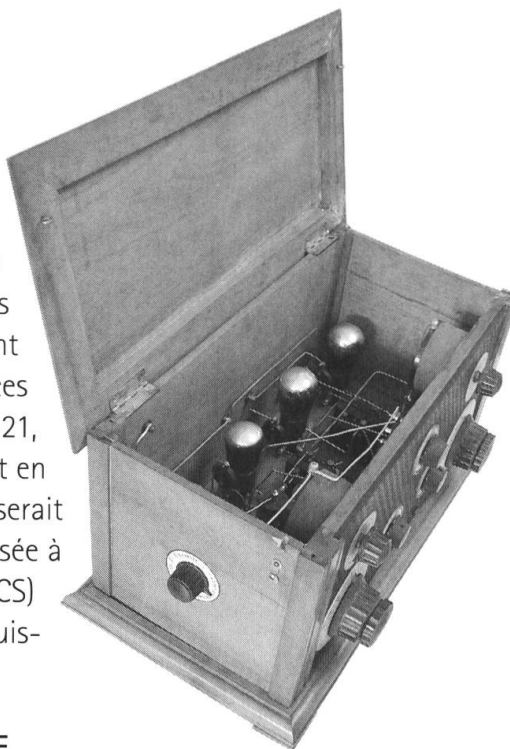
Récepteur fabriqué par un «sans-filiste» amateur (1927), écoute par haut-parleur.
