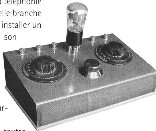
Appareil fabriqué par un amateur (vers 1925). Ecoute au casque.
