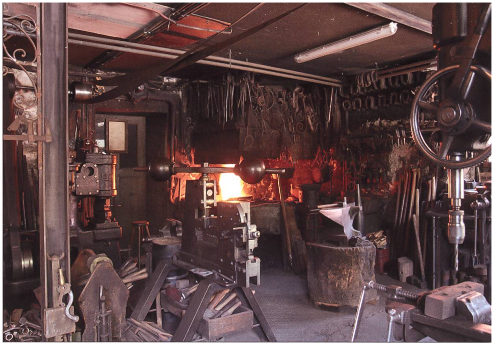
La forge de Charmey, au plafond on voit les courroies de transmission du moteur électrique, © Amis de la vieille forge de Charmey
