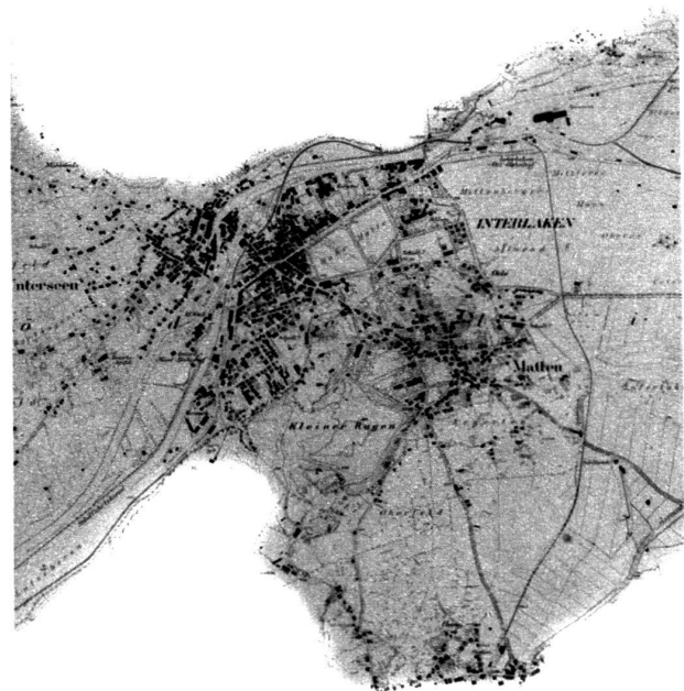
Fig. 4. — La situation est passée à l'encre. Le plan est complété par le levé de cotes et courbes de niveau. La couche photographique est enlevée. Les écritures sont ajoutées lors de l'impression. Echelle 1 : 10,000.
