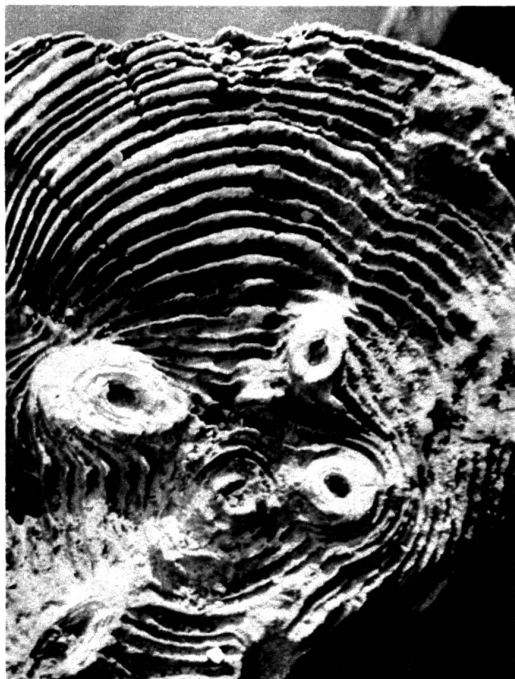
Action du lavage de la pluie sur le bois de bout.
